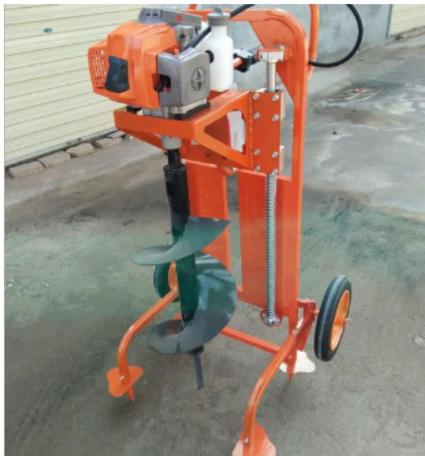
前置式挖坑机的优点：高效：挖坑机动力强劲，直径五十公分、深度两米的土坑大概在1分钟内便能完成，效率是传统人工挖坑方式的百倍以上，是后置式挖坑设备的5-7倍；操作简捷：挖坑机实现了驾驶与操作的一体化，1-2名操作人员可顺利完成各种土坑的挖钻工作；作业质量高：该设备采用钻头前置式设计，较后置式更易找准钻点。采用度钻头，抗扭、抗拉螺旋钻杆，中心定位，挖出的土坑直、实，坑内土余量少，比较大深度能达到3.5米；适应性强：由于采用拖拉机或挖掘机为该设备制造平台，该类型设备具备较强的越野性能，丘陵、山地等复杂地形均能良好适应，能在黄土层、黏土层、含鹅卵石砂砾土层、风化岩土层、冻土层、建筑回填垃圾、全沙层、生活垃圾层等大部分土质上施工作业；应用范围广：该设备可广泛应用于电力电信工程、市政工程、绿化植树工程、建筑施工工程、太阳能光伏发电工程等。东营多功能机械设备供应商潍坊值得信赖的机械设备厂家。
